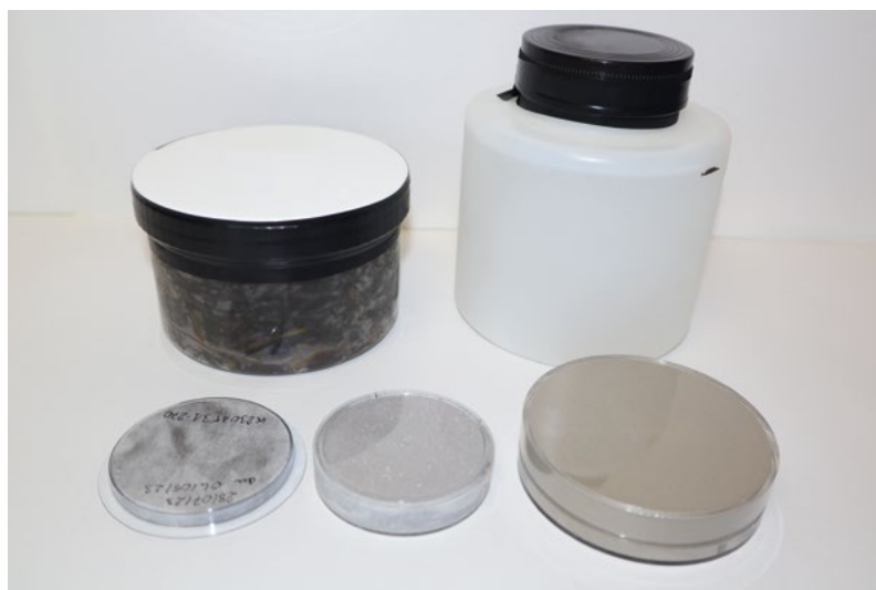
FIGURE 14 / EXEMPLES D'ÉCHANTILLONS MESURÉS EN SPECTROMÉTRIE GAMMA, CONDITIONNÉS DANS DIFFÉRENTES GÉOMÉTRIES (de gauche à droite et de bas en haut : filtre d'aérosols, poisson en cendres, sédiments en sec, algues en frais, eau liquide)
