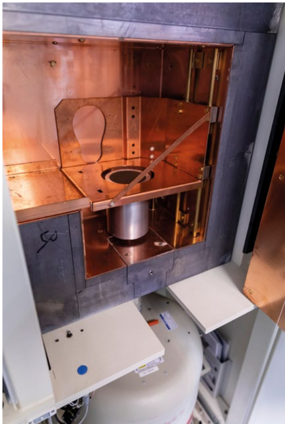
FIGURE 13 / DÉTECTEUR GERMANIUM HYPER PUR UTILISÉ POUR LA MESURE PAR SPECTROMÉTRIE GAMMA
