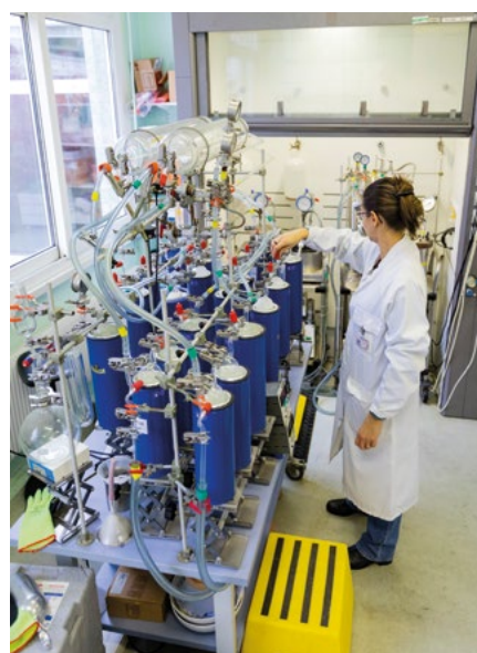
FIGURE 1 / MONTAGE POUR LA SYNTHÈSE BENZÉNIQUE
